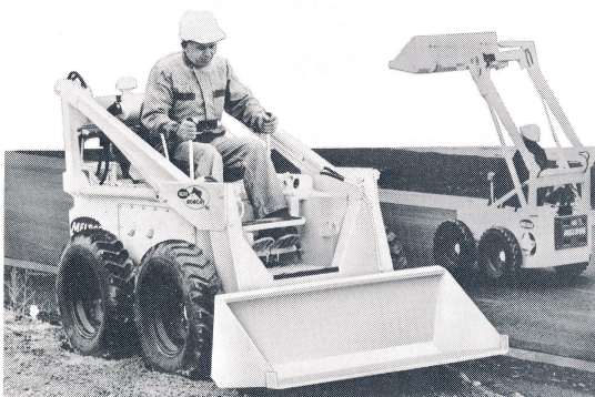
25-hp VF4D powering front-end loader
