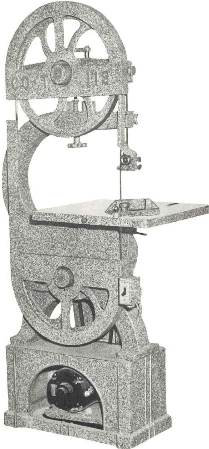
La scie à ruban CO-T 119 est faite entièrement de fonte solide. Les roues sont sur coussinets à billes. Les guides du haut et du bas sont sur coussinets à billes. La table est rainurée pour le guide d'onglet fourni avec la machine.
