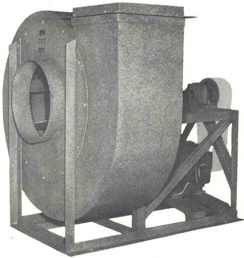
Les souffleurs CO-T 93 et 94 sont faits d'acier épais et sont montés sur une base de bonnes dimensions. L'éventail est bien balancé et tourne sur des coussinets à billes. Ces caractéristiques assurent un fonctionnement doux et exempt de vibration.
