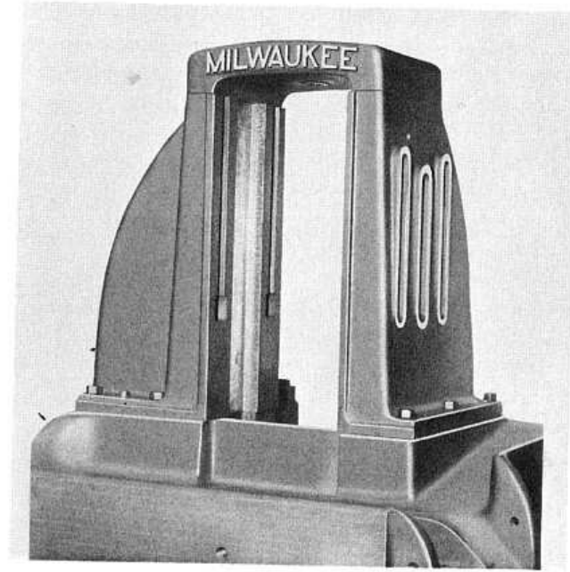
Fig. 16. Spindle upright unit
