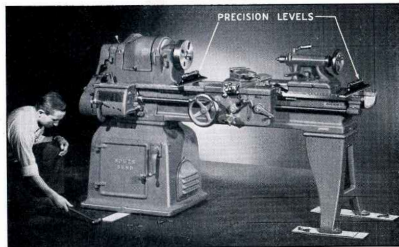
Fig. 23. Leveling the Lathe
