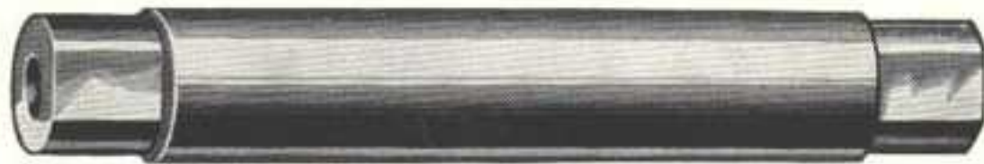
Fig. 269. A Steel Lathe Mandrel
